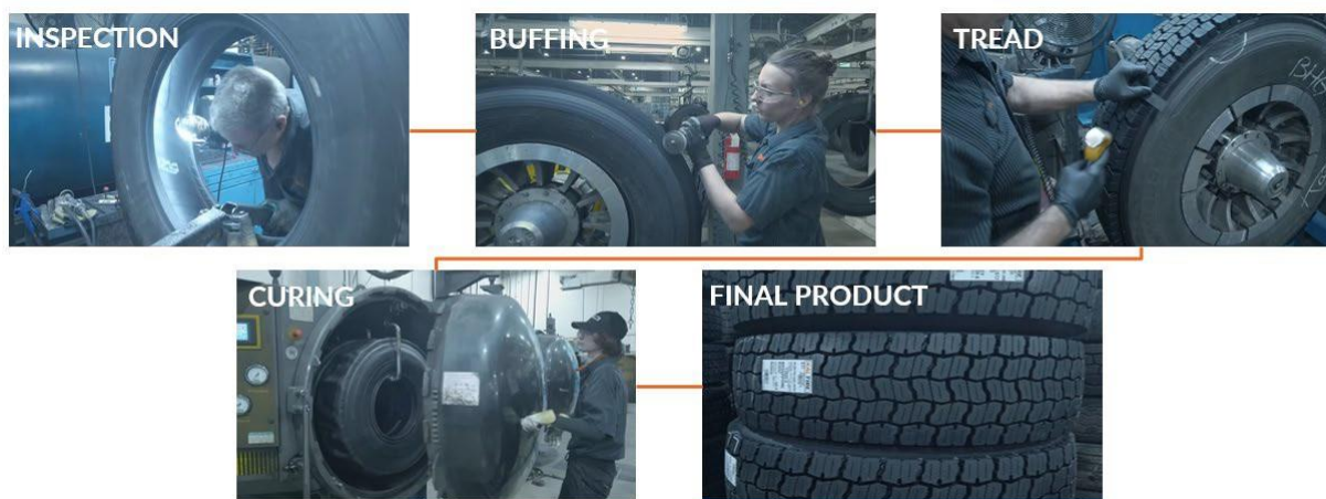
Figure 1 : Étapes du processus de rechapage
